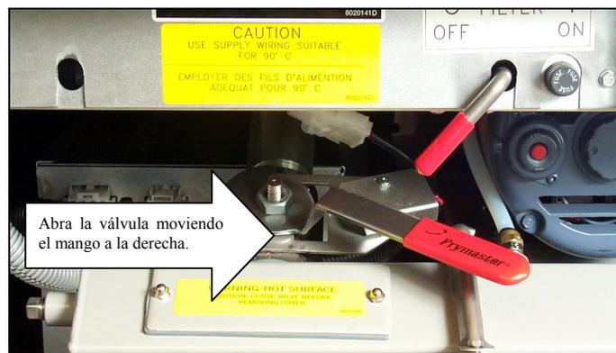
**Abra la válvula de drenaje de la olla y drene el aceite dentro de la fuente del filtro.**
